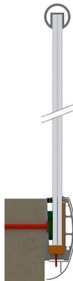
Además, gracias a la **compatibilidad de las Series Railing & Basic Pro**, se logran integrar los dos productos en una misma instalación. La barandilla se sirve de un pasamanos que hace de guía para la cortina de cristal. Todos los perfiles son personalizables, ofreciendo una solución integral, ya que disponemos de un amplio catálogo de soportes, componentes, piezas de alineamiento de vidrios y accesorios que convertirán cualquier idea en una realidad sobre la que apoyarse.
