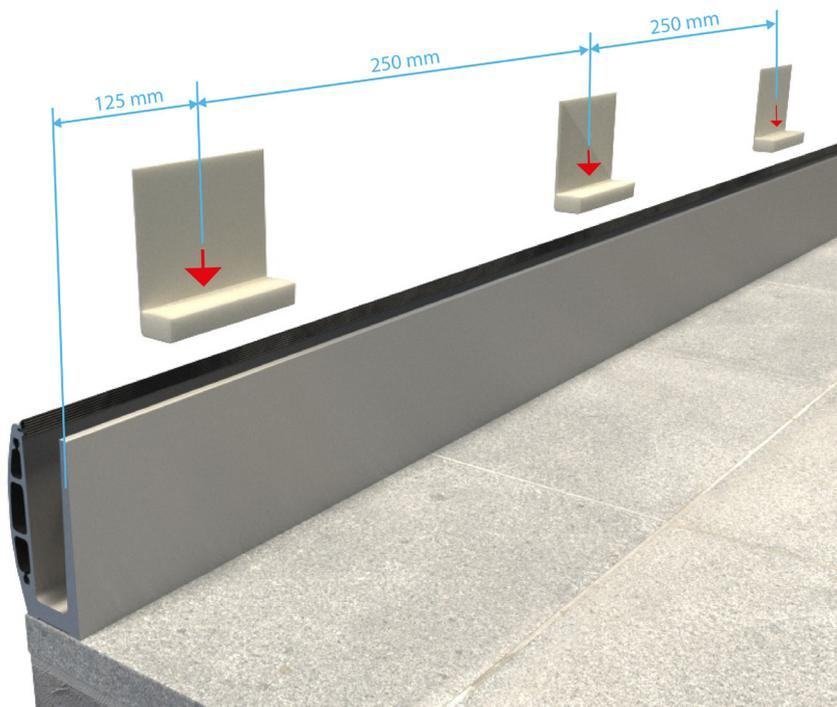
4. Introducir los vidrios dejando una separación entre ellos de 10mm, utilizar las piezas de neopreno para cubrir el espacio de perfil Railing que queda entre vidrio y vidrio.
