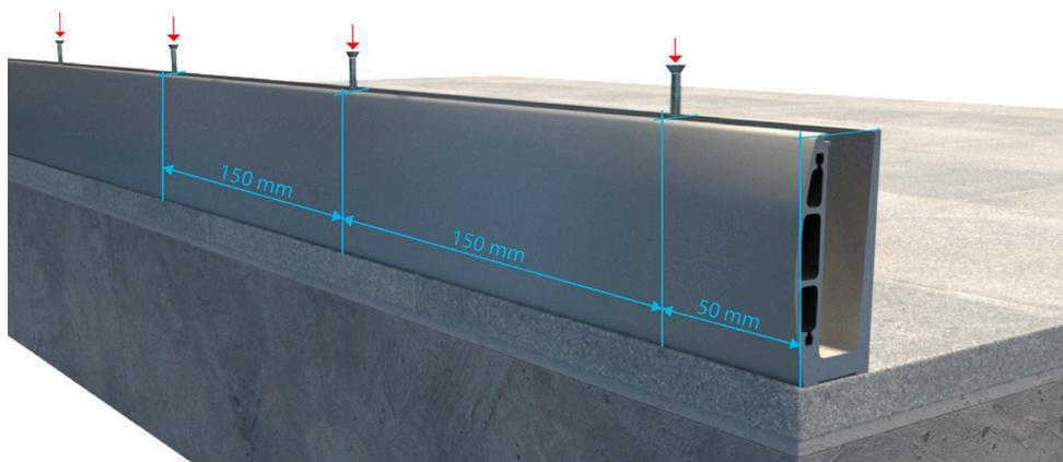
**1. Opción B:** Anclaje en compuesto químico de resina y una varilla roscada M10, encastrada 120 mm, sobresaliendo 25 mm. Distancia entre fijaciones 150 mm y 50 mm a los extremos.
