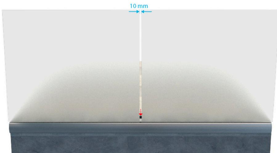
5. Los calzos de fijación se colocan a presión y centrados sobre los asientos previamente instalados.
