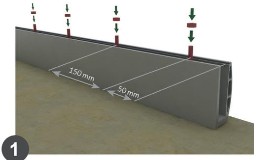
1 La distance entre les fixations est de 150 mms et a 50mm des extrémités, considérant un ancrage chimique composé de résine et d'une tige fileté M10 encastrée 120 mms.
