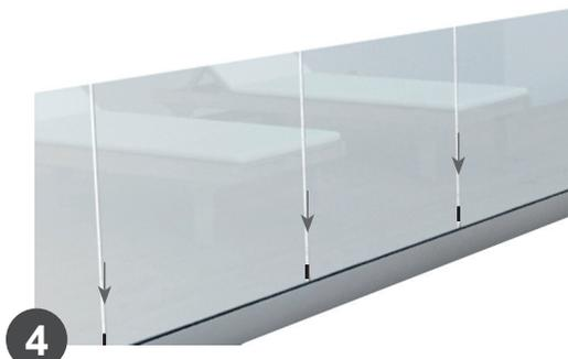
4 Introduire les verres en laissant une séparation entre eux de 10 mms, en utilisant le joint mousant-adhésive pour couvrir l'espace du profil Railing qui reste entre verre et verre.
