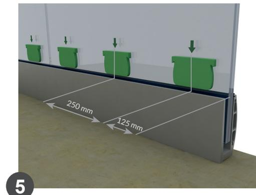
5 Les cales de fixation se placent en les introduisant sous pression et centrés sur les sièges préalablement installés.
