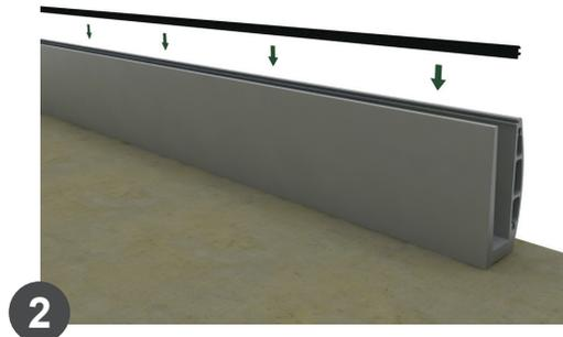
2 Introduire en pression le joint de la face extérieur du profil Railing.
