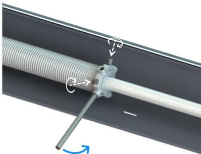
Una vez realizado cualquiera de los pasos anteriores, **sin soltar la barra que mantiene la tensión del muelle, deberá volver a atornillar los dos tornillos que fijan el muelle al eje.** Se recomienda alojar uno de los dos tornillos en la ranura del eje.
