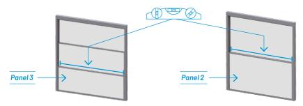
Si el panel no está nivelado, deberá aflojar los tornillos hexagonales para girar la tuerca inferior y nivelarlo (ver imágenes siguientes), será importante volver a apretar los tornillos una vez terminada la nivelación. **Hágalo a ambos lados del panel.**
