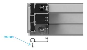
Paso 15. Colocación de las tapas de las guías
