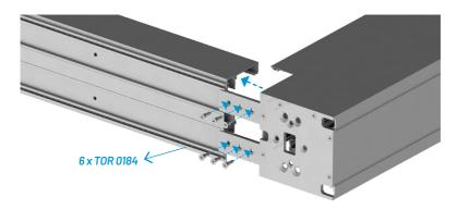
Ensamblar y fijar el perfil inferior a los marcos laterales.
