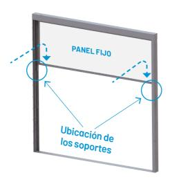
Nivélelo y fíjelo a ambos lados de la base del marco lateral en las cuatro esquinas que verá en el panel como en la imagen siguiente. **Atornillar en las 4 esquinas.**
