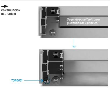
Paso 12. instalación y fijación del panel fijo
