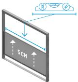
Si el panel no está nivelado, deberá aflojar los tornillos hexagonales para girar la tuerca inferior y nivelarlo (ver imágenes siguientes), será importante volver a apretar los tornillos una vez terminada la nivelación.
